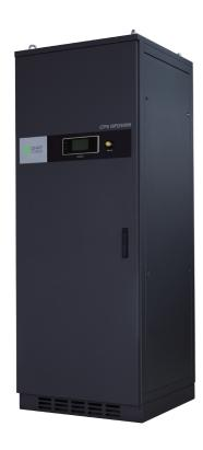
光伏防雷直流柜主要作用是二级汇流,即将前端汇流箱输出进行汇流后接入并网逆变器直流输入侧,主要应用于大中型光伏系统。该直流配电柜主要由断路器、光伏防雷模块、显示仪表等设备组成,另外还有监测模块、防反二极管、绝缘监测装置等可选功能设备,具有分断能力高、动热稳定性好,结构合理,高可靠性,系列性、适用性强等特性。内部布置简洁明了,布线整齐合理,方便操作与维护,可按客户需求定制。
